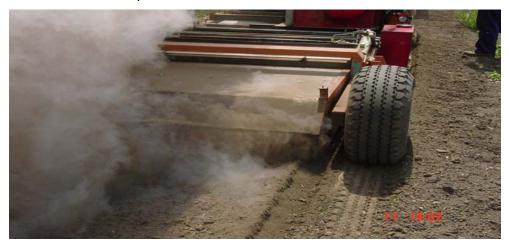
Abb. 4: Thermokammer, in der die Bodenpartikel mit Hilfe der Umkehrfräsen geschleudert werden und somit hohen Temperaturwerten ausgesetzt sind
