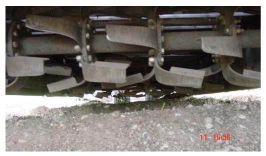
Abb. 3: Umkehrbodenfräse mit Rotation gegen die Arbeitsrichtung zur besseren Zerkleinerung der Bodenpartikel bei variabler Tiefeneinstellung
