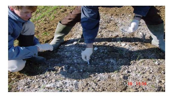
Abb. 12: Einbringung der mit den "Prüfkeimen" kontaminierten Keimträgern in ca. 5 cm Bodentiefe der jeweils gekalkten Versuchsflächen
