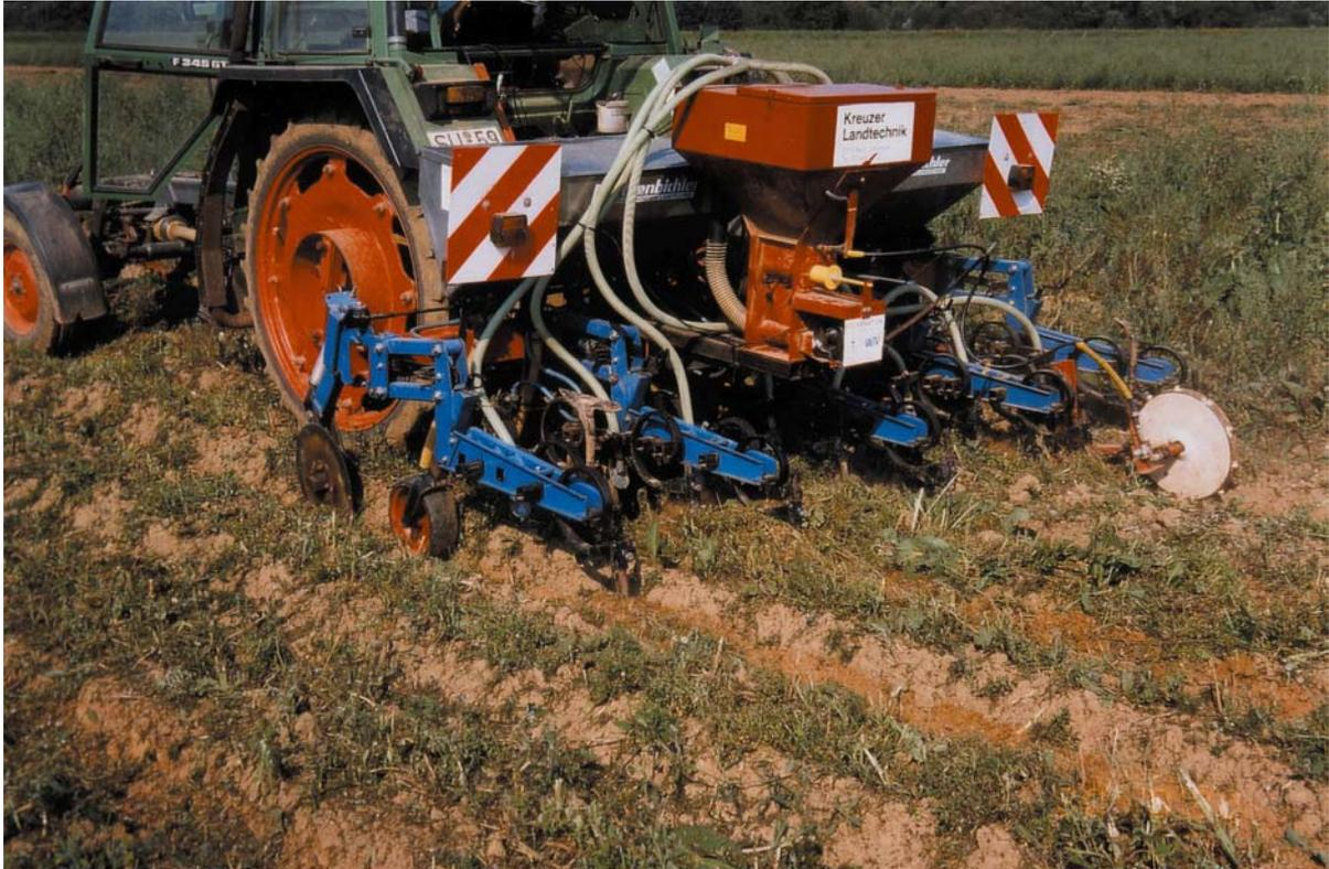
**Abb. 2: Furchensaat von Mais und Sonnenblumen mit einer für Untersaaten in Mais verwendeten Sämaschine (Testversuch nach Krautabschlegeln)**
