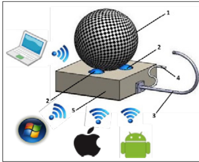
Figura 2. Modelo de esboço do simulador optocinético desenvolvido
