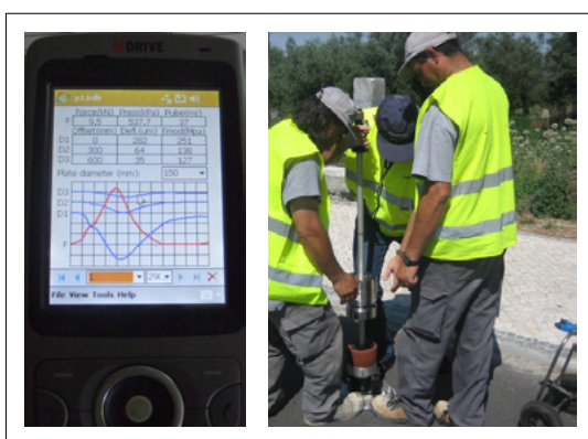
Figura 10. Ensaio de carga com DIL: PDA de monitorização dos ensaios (esquerda); aplicação de carga sobre o pavimento (direita).
