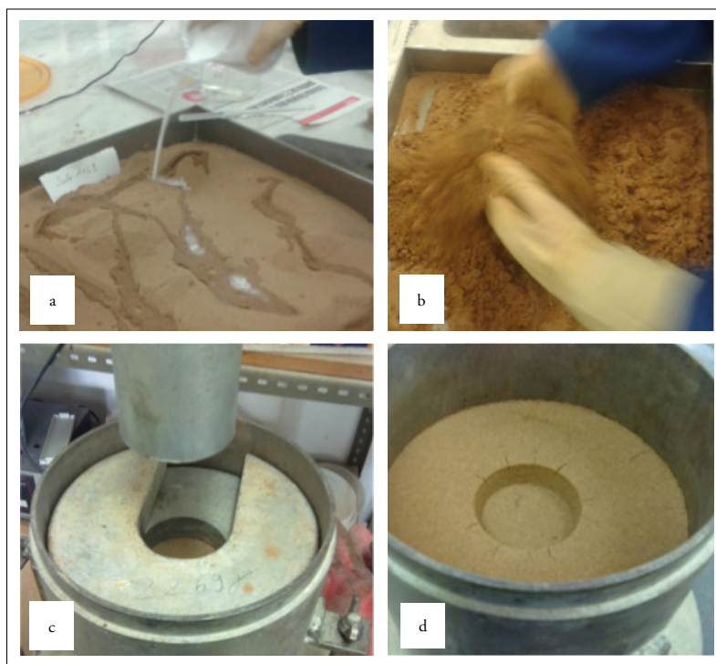
Figura 7. Adição de emulsão ao solo (a); homogeneização do solo (b); penetração da amostra para medição do CBR (c); amostra após realização do ensaio de resistência (d)
