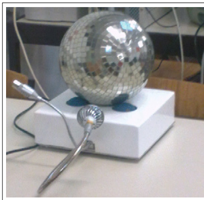
Figura 3. Protótipo físico do estimulador optocinético desenvolvido
