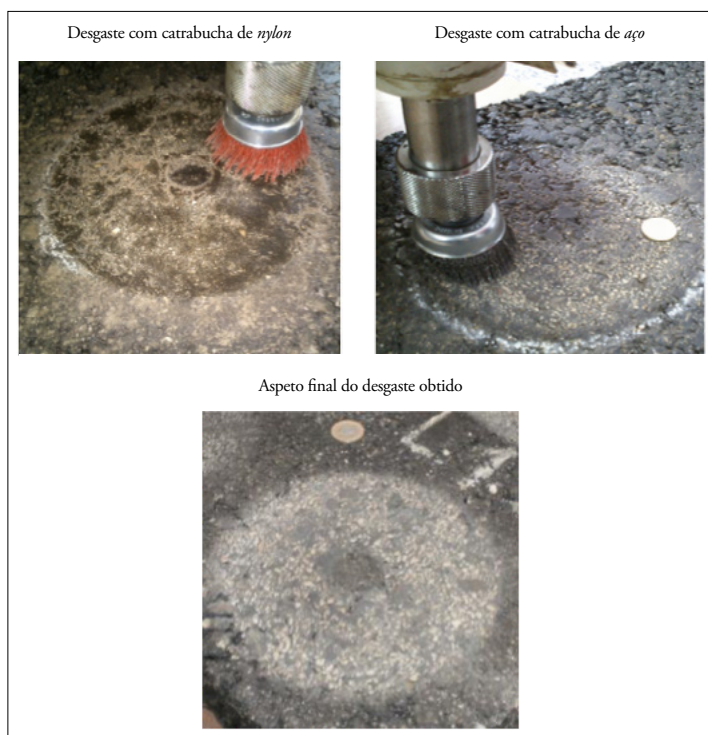
Figura 4. Processo de desgaste efetuados sobre amostras de camada de desgaste (Sardão et al., 2013)
