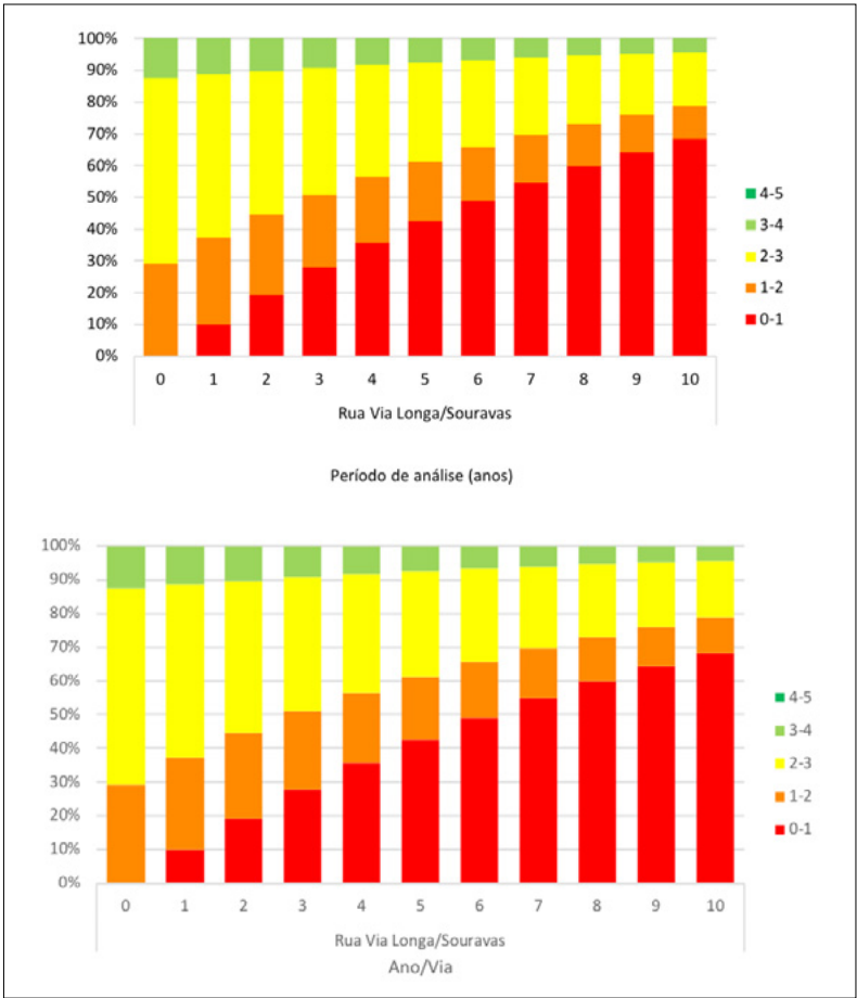
Figura 2. Exemplo de previsão da extensão de vias (em percentagem) com diferentes níveis de qualidade ao longo de 10 anos, sem a aplicação de ações de conservação (Ribeiro, Capitão & Correia, 2017)
