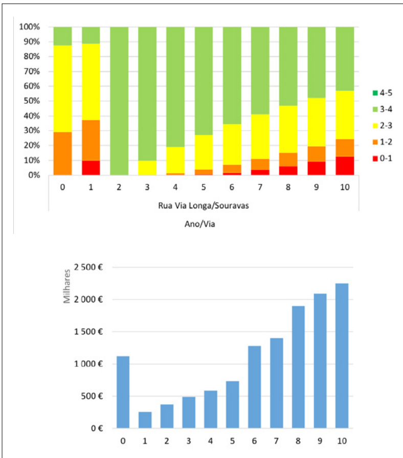
Figura 3. Exemplos de previsão da extensão de uma via com diferentes níveis de qualidade após a aplicação de uma ação de conservação (esquerda) e investimento necessário em cada ano (Ribeiro, Capitão & Correia, 2017)
