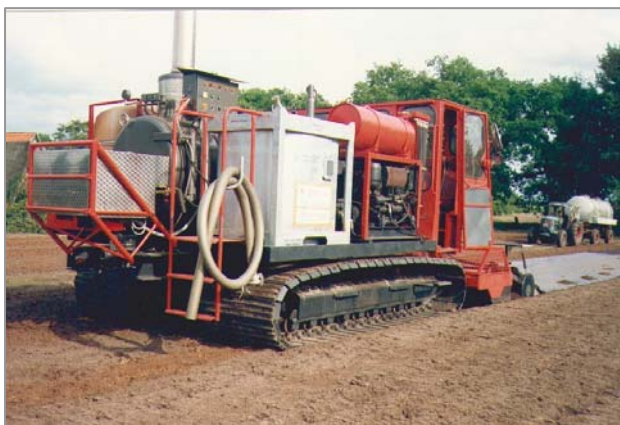
Abb. 5: Dämpfraupe System Möschle; plantec-Auszeichnung 1991
