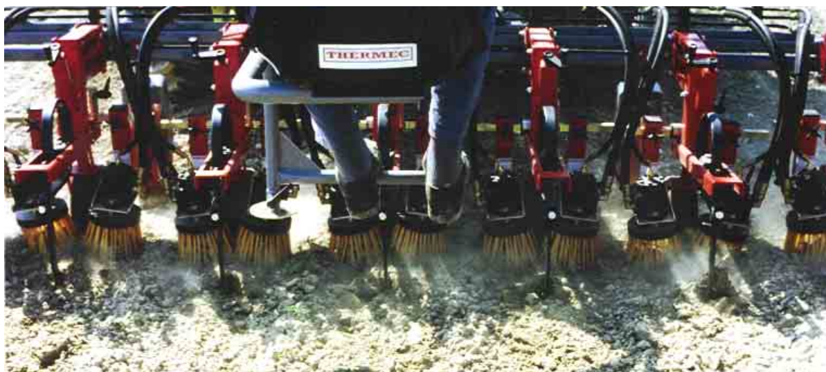
Abbildung 1: Tellerhackbürste beim Einsatz im Feld
