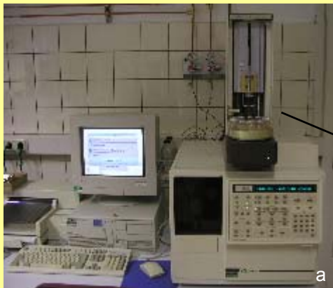
7. Analyse am GC/FID (a) mit automatischer SPME-Injektion (b, c).
