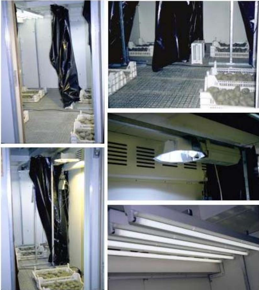
**Abb. 1 – 5:** Klimakammer (oben links, oben rechts, unten links); Leuchte für Son-T-Agro, HQI-BT, HPI-T-Plus (Mitte rechts); Leuchte für Neonlicht (unten rechts)
