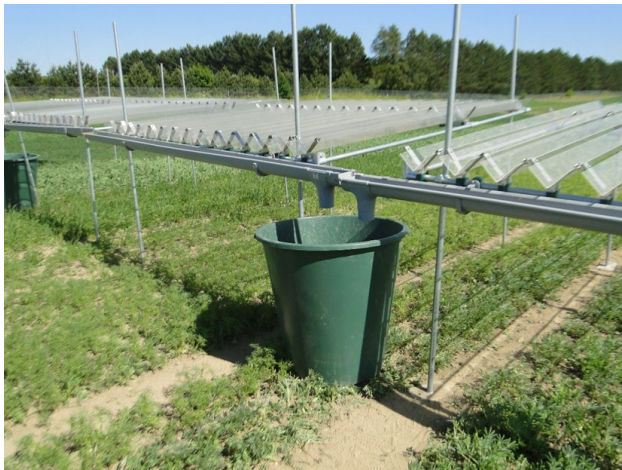
Abbildung 18: Konstruktion von Rainout-Sheltern im Feld über Kichererbsen zur Blüte.
