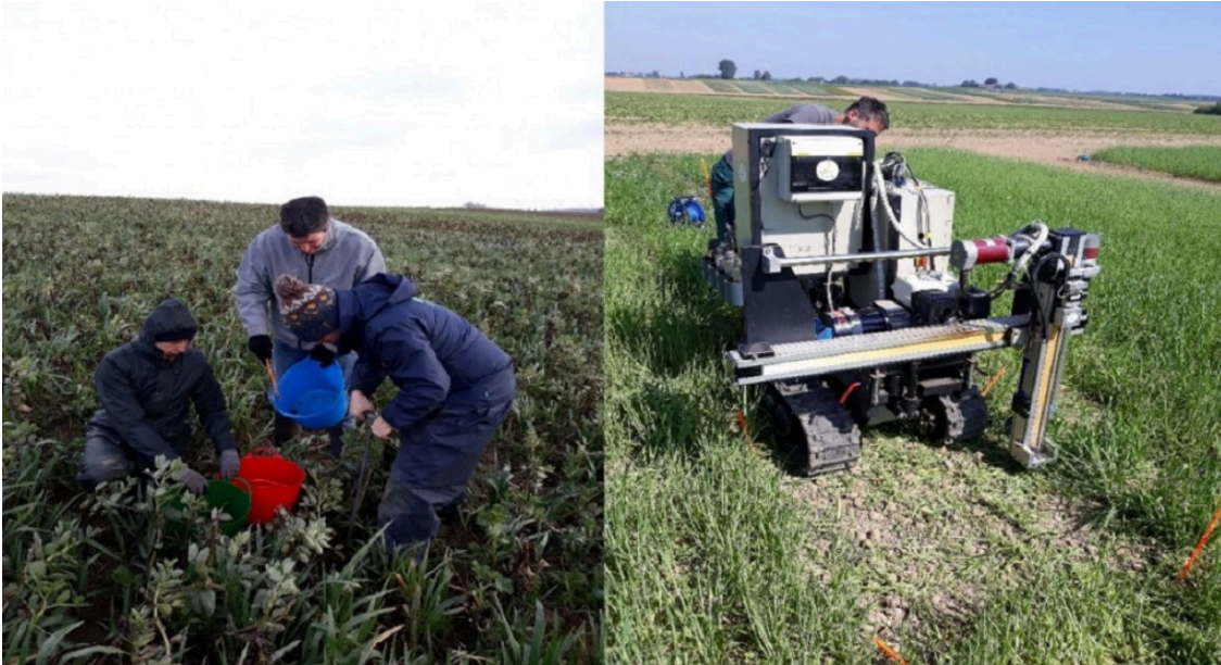
Figure 2: Illustration d'une campagne de prélèvement de sol en sortie d'hiver dans une culture intermédiaire (gauche) et d'une campagne de mesure pénétrométrique (droite)
