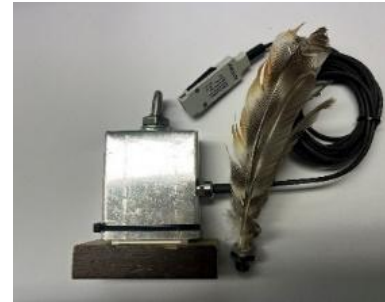
Abbildung 4.5: Kraftmessgerät (Eigenentwicklung Institut für Landtechnik)
