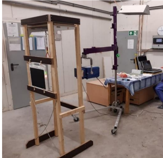
Abbildung 3.2: Gestell zur latero-lateralen Röntgenaufnahmen der Tiere
