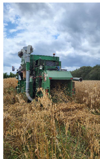
Figure 5 : Moissonneuse d'essais utilisée pour récolter les micro-parcelles des plateformes d'essais à Bouchemaine en 2024 et 2025.
