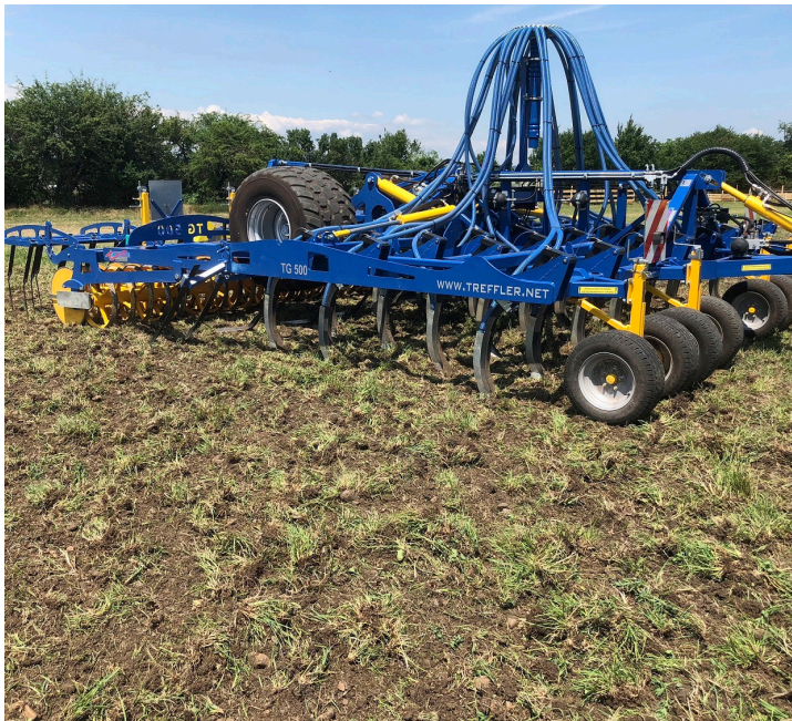
Wichtig ist eine gleichmässige, flache Bodenbearbeitung mit ganzflächigem Durchschneiden. BILD: FiBL
