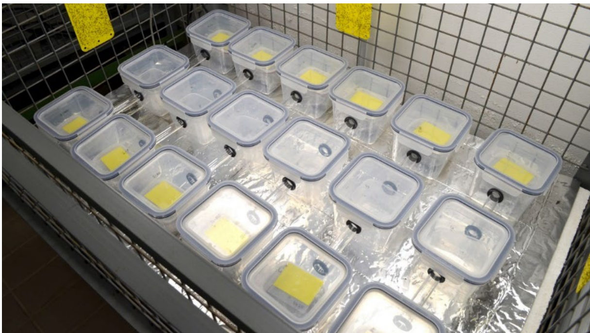
Abb. 4: Aufstellung der Dual-Choice-Arenen im Kulturraum bei 20 °C und einer Tageslänge von 14 h (LED-Belichtung)
