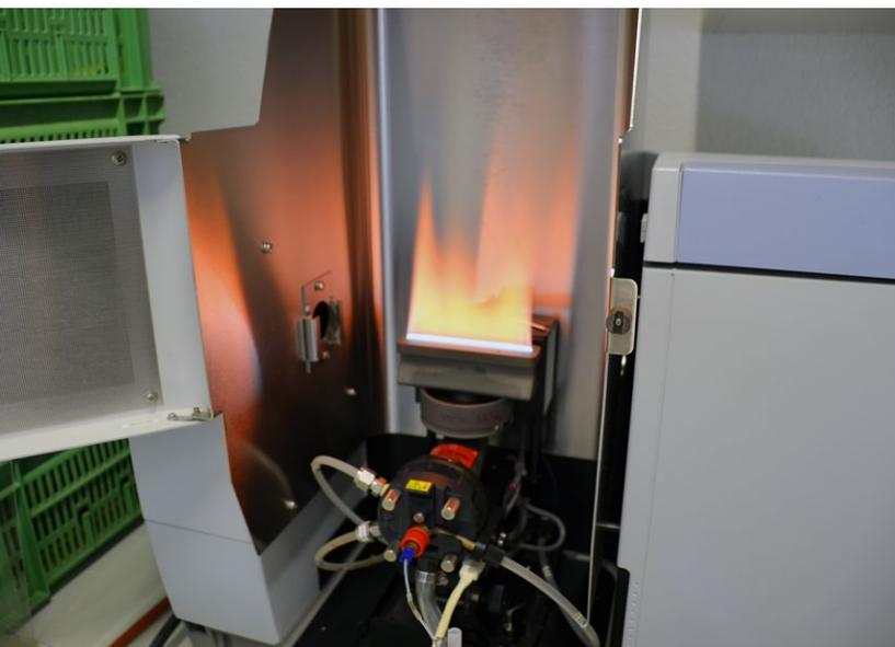
Im Atom-Absorptions-Spektrometer wird ein Teil der Lösung verbrannt. Die Intensität der Flammenfärbung gibt Aufschluss über den Kalium- und Magnesiumgehalt.
