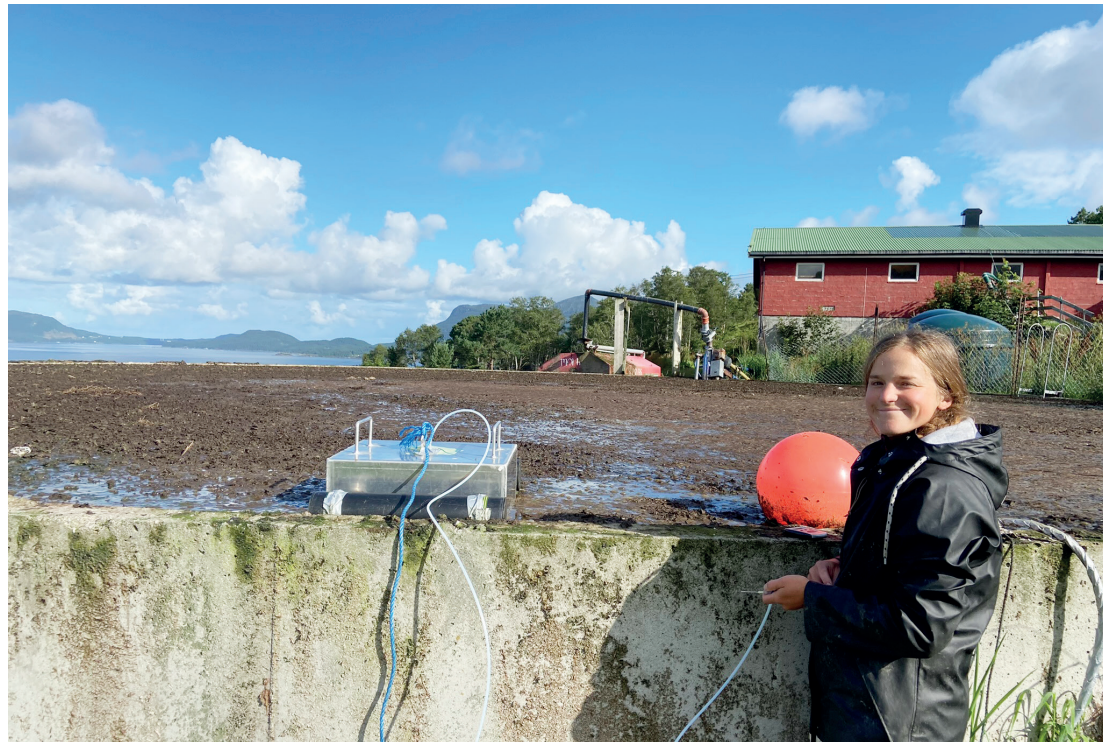
Det finnes tusenvis av gjødsellager på melkegårder over hele landet. Møkka brytes ned av mikroorganismer, noe som gir store utslipp av klimagassen metan. Her er rådgiver Sara Hansdotter i gang med målinger i et av disse lagrene. (Foto: Sissel Hansen)
