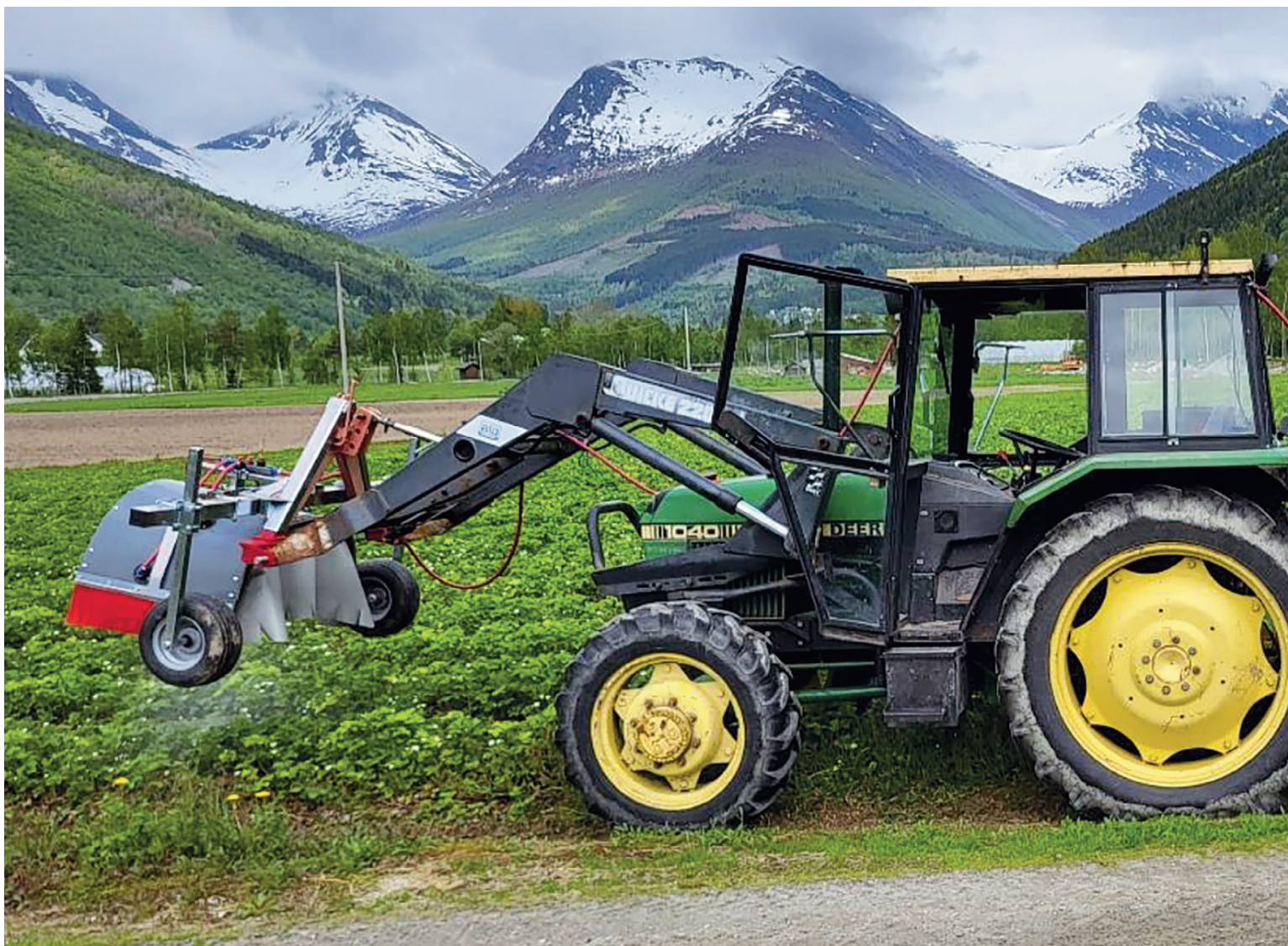
Traktor med åkersprøyte påmontert ozongenerator og strømaggregat. På bilde ser vi også Bjørnar Henden fra Redox AS og Aksel Døving fra NLR SA. (Foto: A. Wibe)
