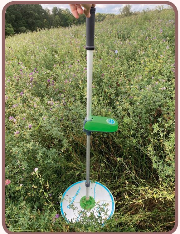
**Abbildung 40:** Im EIP-Projekt „Mob Grazing im Ackerfutterbau“ wurde das *Rising Plate Meter Grasshopper*® von TrueNorth Technologies eingesetzt. Mit Hilfe eines Ultraschallsensors können Aufwuchshöhen im Millimeterbereich gemessen und per Bluetooth an das Handy geschickt werden. Aufgrund des hohen und dennoch lockeren Bestandes sinkt die Scheibe des Instrumentes relativ weit herunter. Für hohe Bestände sind daher methodische Weiterentwicklungen notwendig.
