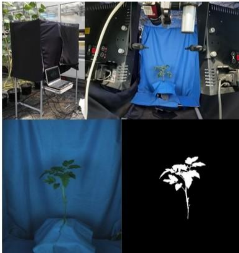
Abbildung 3.1.2: Photobox und Aufnahme von Drehtisch, Kamera und LED-Paneele zur gleichmäßigen Beleuchtung der Aufnahmen (oben). Segmentierung der „Projizierten Blattfläche“ (rechts unten) einer Tomatenpflanze, nach Aufnahme in der Photobox (links unten).
