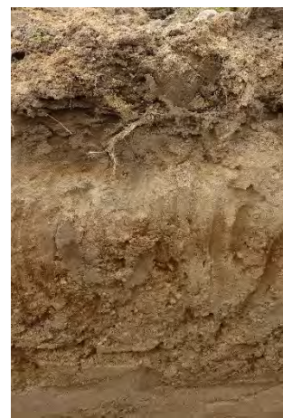
toniger Sand Wasserhalte- fähigkeit (1 m): 120 mm (pflanzen- verfügbar)
