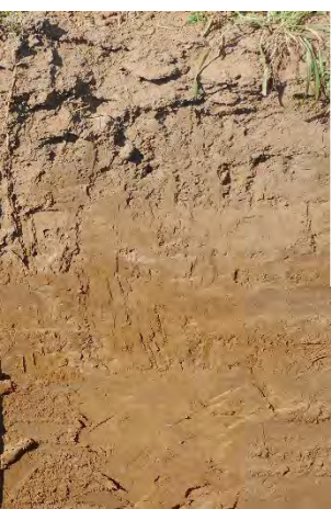
toniger Schluff Wasserhalte- fähigkeit (1 m): 220 mm (pflanzen- verfügbar)
