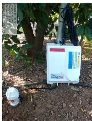
Figura 3. Sonda de capacitância
