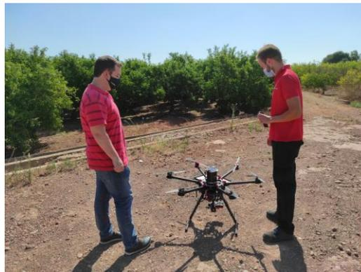
Figura 3. Drone equipado com câmaras termográficas
