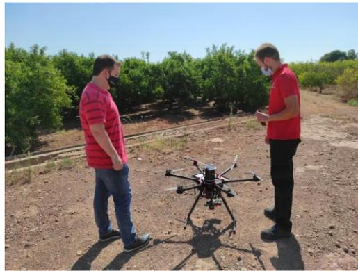
Imagen 3. Dron equipado con cámaras termográficas
