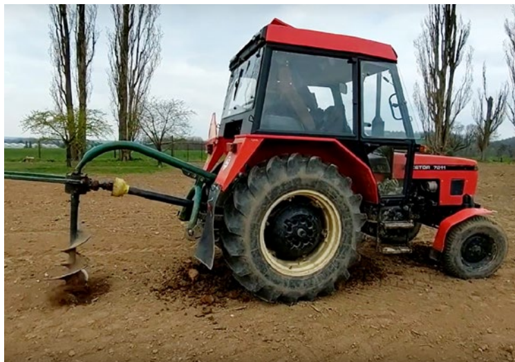
Une tarière pour tracteur peut faciliter le travail de plantation. Selon la taille des plantes, il existe aussi des tarières portatives qui font très bien l'affaire.
