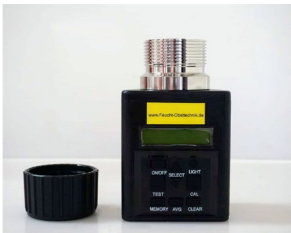
La teneur en eau et la durée optimale de séchage peut être déterminée avec un humidimètre.
