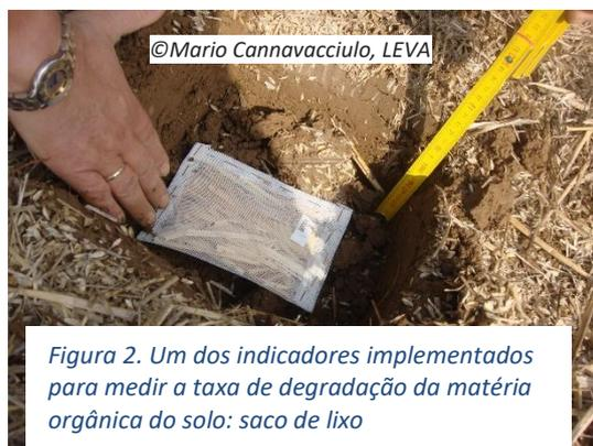
Figura 2. Um dos indicadores implementados para medir a taxa de degradação da matéria orgânica do solo: saco de lixo
