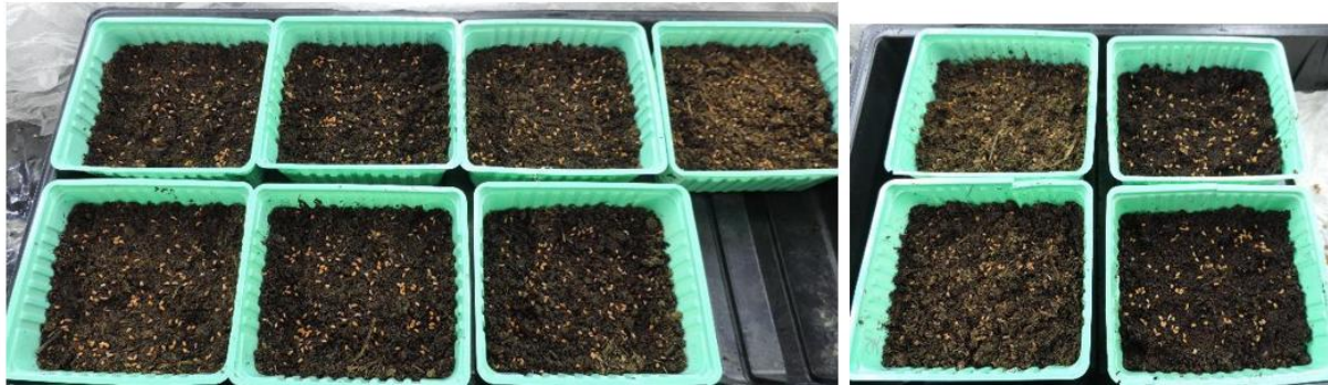
Bilde 5. Oppsett av karsetest 1 med komposter fra termoflaskekompostering (Kompost 2 lab Med biokull/ Kompost 2 lab Uten biokull, rankekompost fra gård 2 (Kompost 2 felt) og referansejord Proline. Oppstart 21. februar 2024. Foto: K. McKinnon
