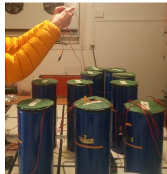
Bilde 3. Kontrollert kompostering i Dewar-flasker.
