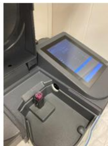
Bilde 3. Kompost blandes med en kjent konsentrasjon av permanganatløsning, ristes kraftig på en maskin og væske fra dette tynnes ut og has i små gjennomsiktige rør (t.v.). Jo mer farge som er igjen, desto mindre aktivt karbon er det i prøven (m). Prøvene leses av i en maskin (t.h.), for så å omregnes til mengde aktivt karbon pr gram tørt kompost. Foto R. Pommersche.
