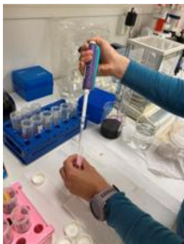
Bilde 3. Kompost blandes med en kjent konsentrasjon av permanganatløsning, ristes kraftig på en maskin og væske fra dette tynnes ut og has i små gjennomsiktige rør (t.v.). Jo mer farge som er igjen, desto mindre aktivt karbon er det i prøven (m). Prøvene leses av i en maskin (t.h.), for så å omregnes til mengde aktivt karbon pr gram tørt kompost. Foto R. Pommersche.
