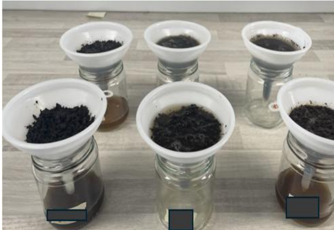
Bilde 1. Test av kompostenes evne til å holde på vann. En bomullsdott ble plassert i tuten som filter. Foto: K. McKinnon
