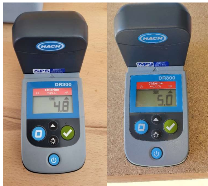
Figur 20. Ozon-konsentrasjonsmålinger av vannet i stålkonteiner ett minutt før (til venstre) og ett minutt etter (til høyre) 3-minuttersbehandlingen av gulrøttene.
