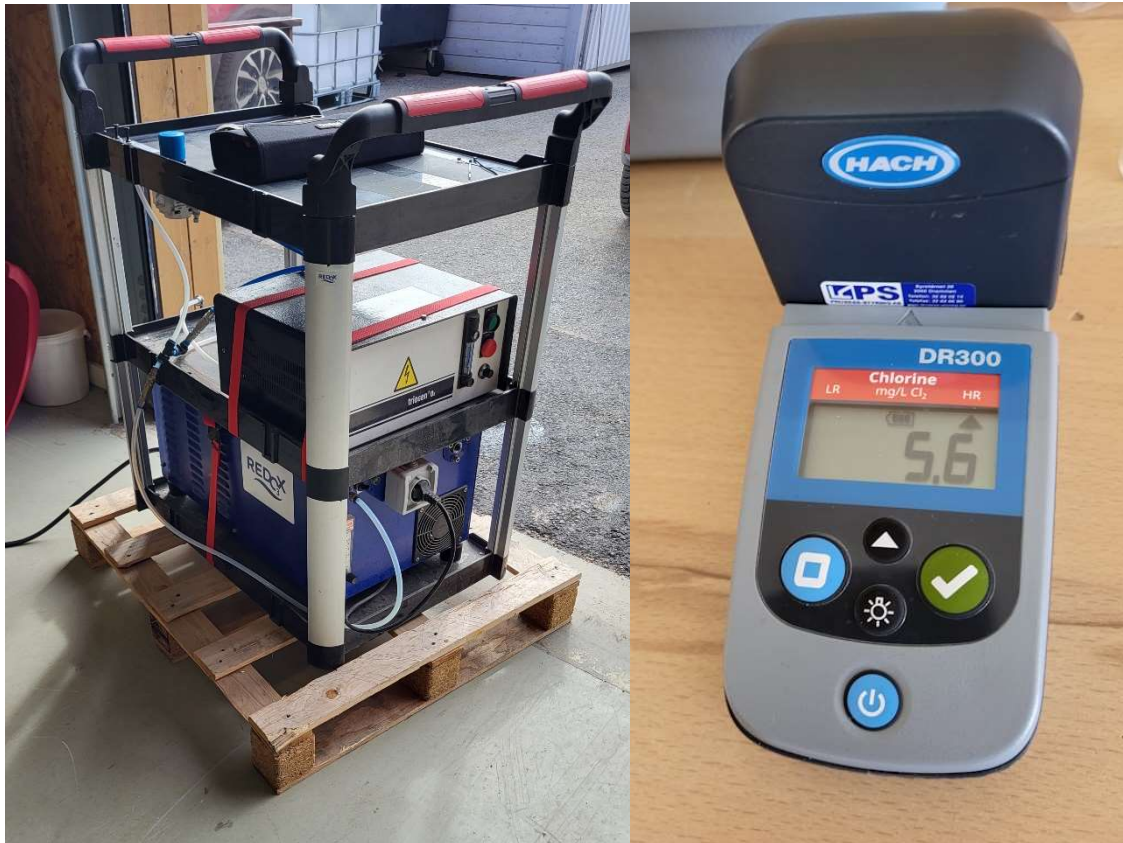
Figur 6. Bildet til venstre viser ozongenerator, mens bildet til høyre viser måleinstrument for ozonkonsentrasjon, Hach DR300.
