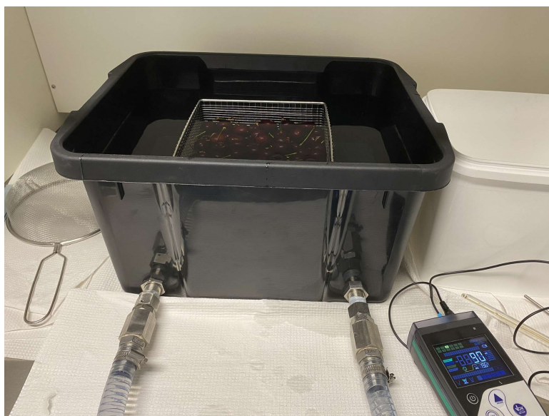
Figur 3. Figuren viser baljen som benyttet for to av morell-batchene som hadde 10 minutters oppholdstid i ozonert vann. Ozonert vann ble sirkulert gjennom denne baljen fra ozoneringstanken ved hjelp av ei pumpe (se figur 2).
