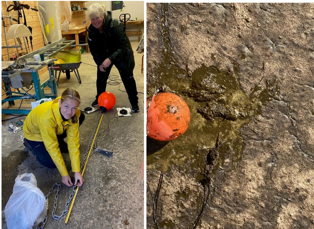
Bilde 7. Festing av sensorer til kjetting for temperaturregistreringer på 0,5 og 1 meters dyp. Blåsa sørger for at sensoren forblir på samme avstand i forhold til gjødseloverflaten. Foto: NORSØK
