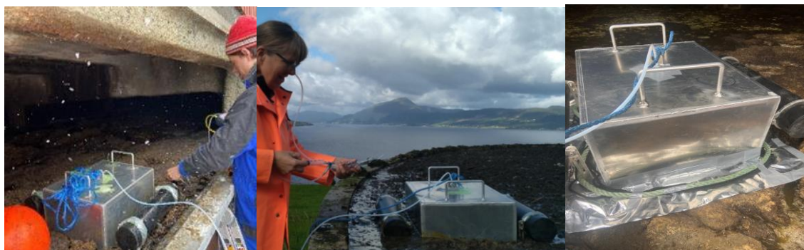
Bilde 10. Uttak av gassprøver ved hjelp av kammer på gjødsellagre. I de to bildene til venstre har kammeret skåret gjennom overflaten, mens kammeret til høyre hviler opp på gjødselskorpa og har ei kappe rundt for å hindre gassdiffusjon. Foto: NORSØK
