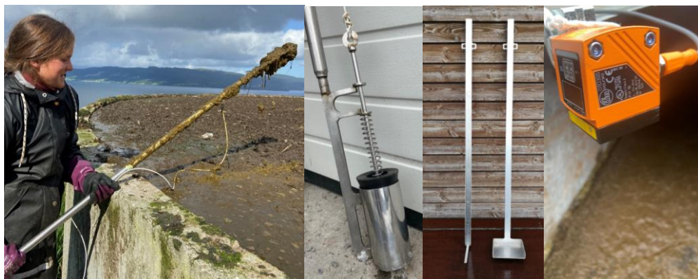
Bilde 9. Fra venstre: gjødselprøvetaker i bruk og i nærbilde, målestav til å bestemme skorpetykkelse, skorpespade og laser for å bestemme avstand til gjødseloverflate. Foto: NORSØK.
