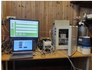
Bilde 12. System for kalibrering av metansensorer. Foto: M. Jakovljevic
