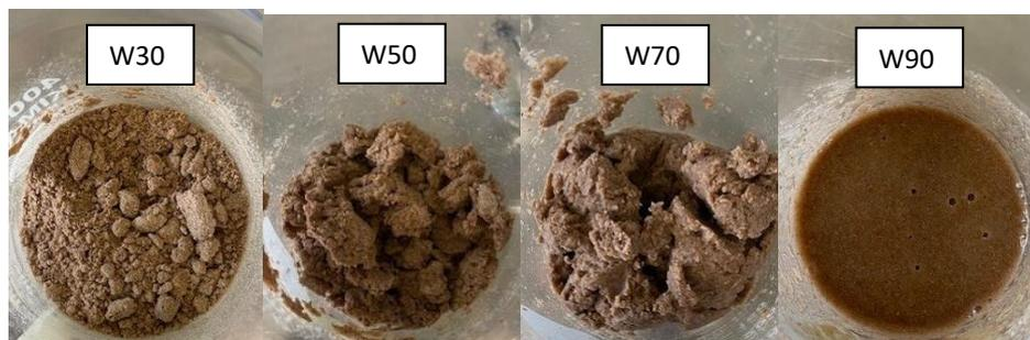
Abbildung 4.76: Fotos von Leinsamenpresskuchen mit verschiedenen Anteilen an Wasserzugabe von 30 % bis 90 %.
