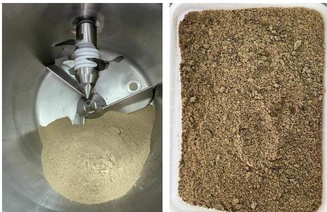
Abbildung 4.74: Leinsamenpresskuchen, zerkleinert in Stiftmühle (links) und zerkleinert im VAS Mischer (rechts)
