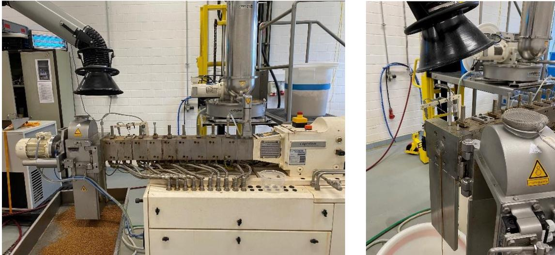
Abbildung 3.5: Aufbau des Extrusionssetups Dry Extrusion zur Herstellung von TVP.
