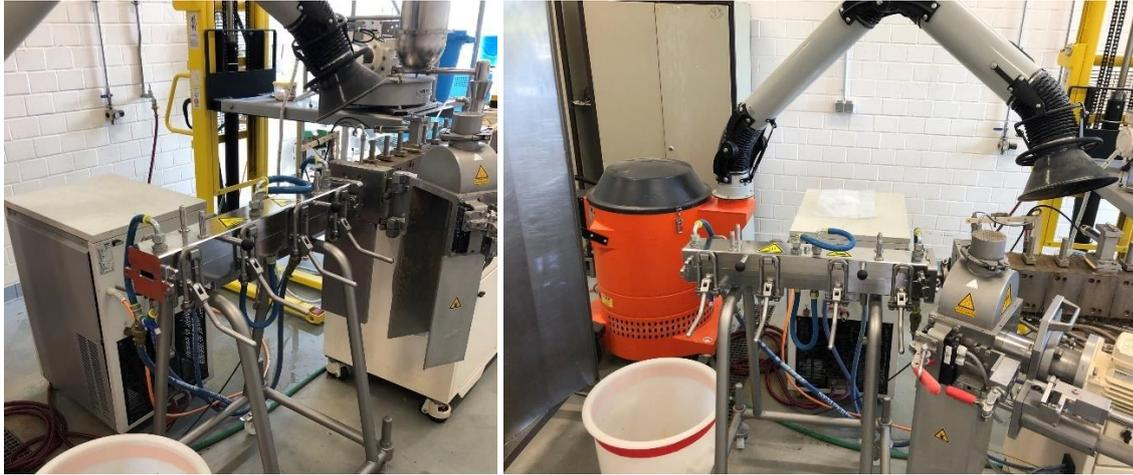
Abbildung 3.6: Aufbau des Extrusionssetups High Moisture Extrusion zur Herstellung von Nassextrudaten.
