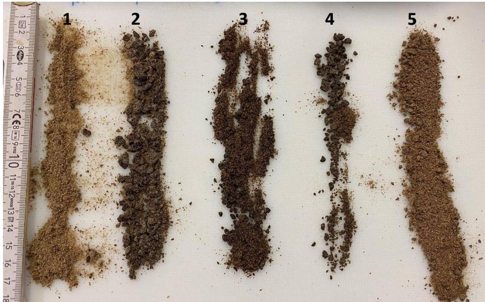
Abbildung 4.69: Leinsamenpresskuchen nach der Behandlung zur Blausäurereduktion: 1: Kontrolle (unbehandelt); 2: Kochen (Variante 2); 3: Enzymatisch (Variante 1) und Dämpfen (120 °C, 6 h); 4: Dämpfen (120 °C, 6 h); 5: Dämpfen (40 °C, 6 h)
