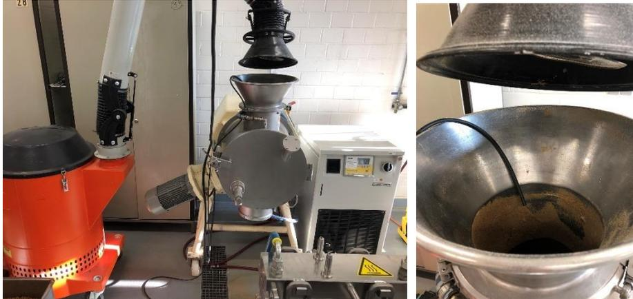
Abbildung 4.77: Inkubation des Leinsamenpresskuchens im Lödige-Mischer mit installierter Absaugung und Gaswächter für Blausäure.
