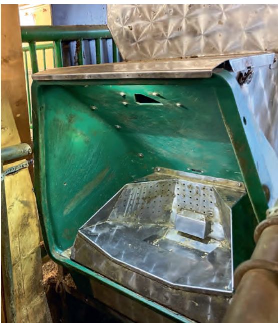
GreenFeed (bildet) og fôrkar er den beste og sikreste metoden for å måle faktisk fôropptak og metanproduksjon. Foto: Turi Nordengen
