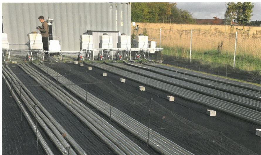
Figur 1. Mikroalge dyrkning i plastikrør placeret hos TI i Høje Tåstrup.
