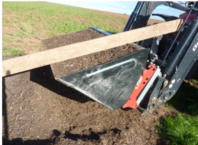
Abbildung 2.6.2 Einwiegen der definierten Volumenmenge (Foto: Zerger)
