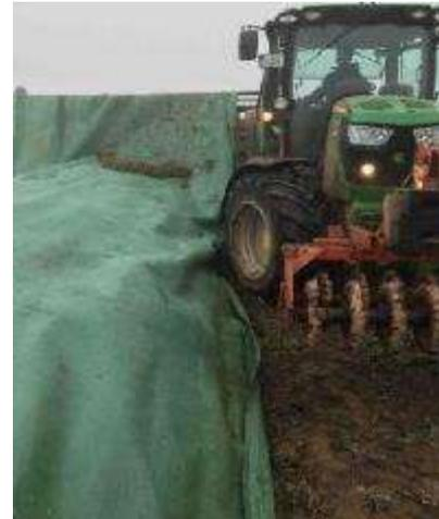
Abbildung 3.2.5 Sichtbehinderung des Fahrers durch die Wickelvorrichtung (Foto: Hellwig-Büscher)
