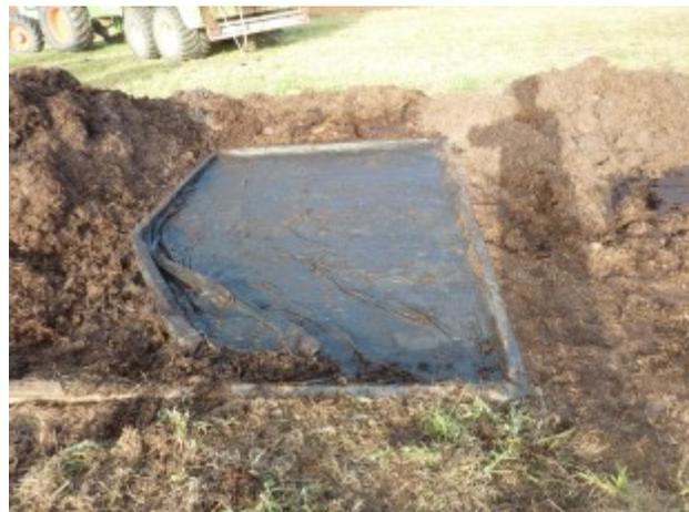
Abbildung 3.3.43 Beschädigte Auffangwanne bei Versuchsende (Foto: Zerger)
