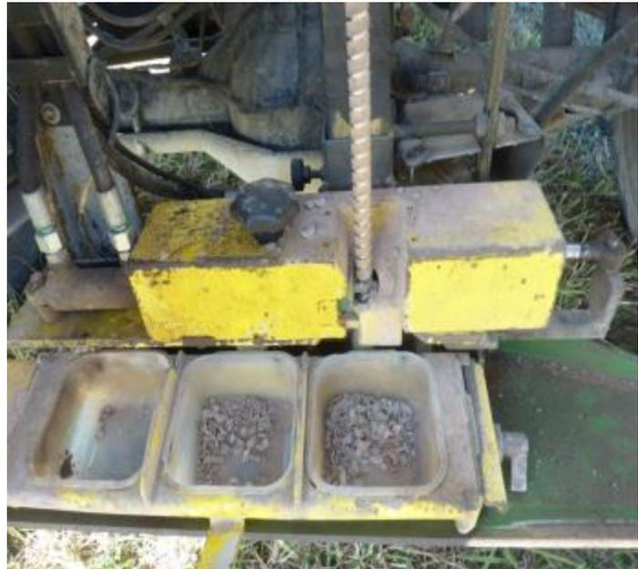
Abbildung 2.4.13 Bohrerergebnisse zu den drei Tiefen 30-60-90cm (Foto: Zerger)
