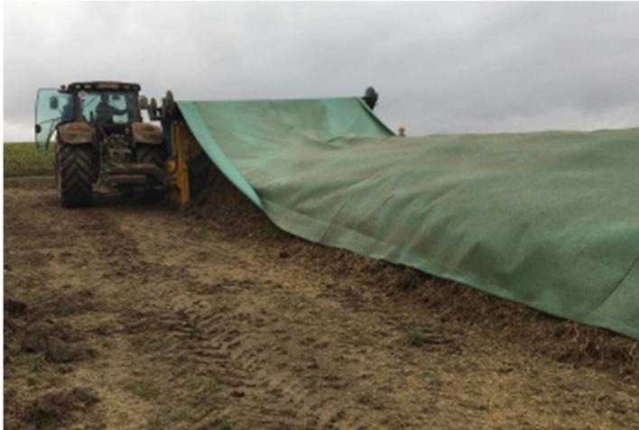
Abbildung 3.2.4 Vliesaufnahme mittels Wickelvorrichtung auf dem Umsetzer (Foto: Hellwig-Büscher)
