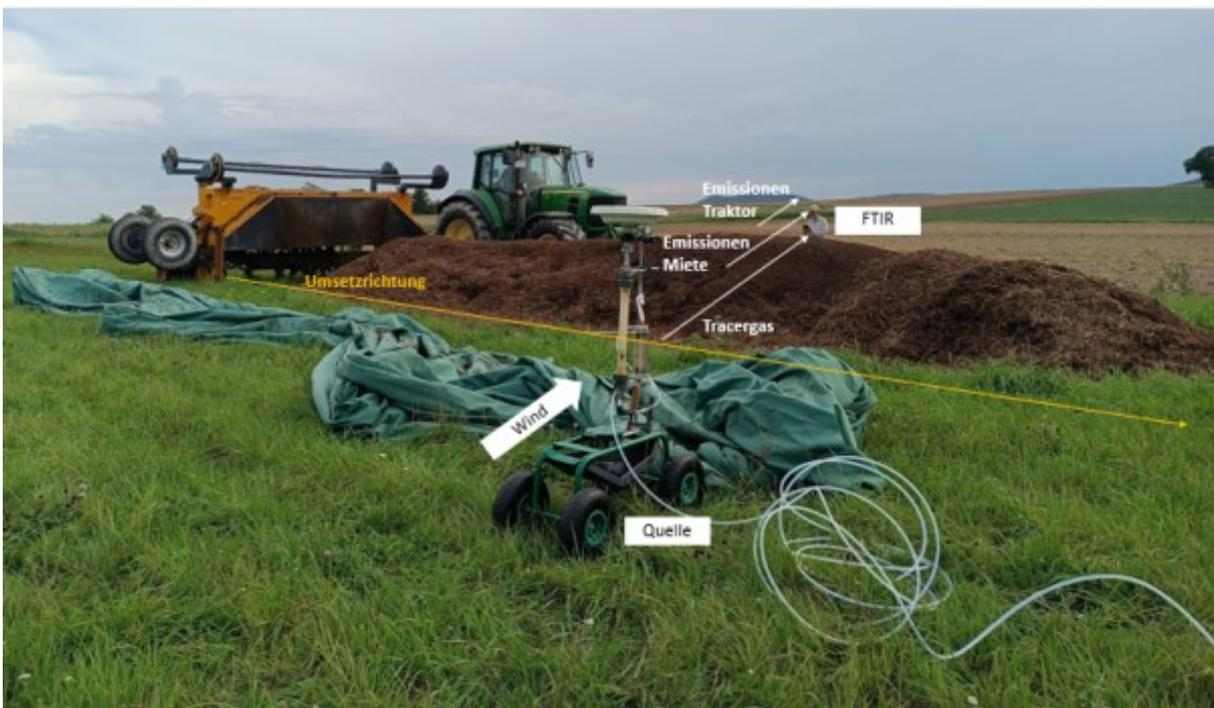
Abbildung 3.3.77 Versuchsaufbau während dem Umsetzen (Foto Universität Stuttgart)
