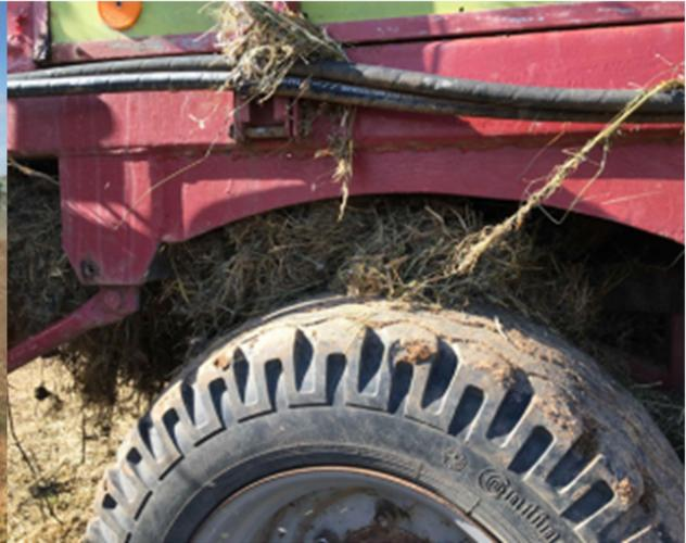
Abbildung 3.3.4 Verstopfung durch Pflanzenfasern (Foto: Hellwig-Büscher)
