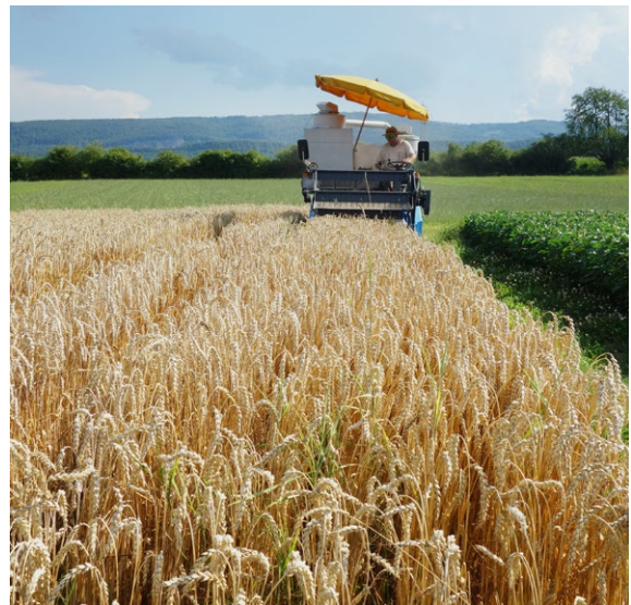
Mähdrusch des Randbereichs einer Winterweizenparzelle. Nur der Kernbereich der Parzelle wird zur exakten Ertragsermittlung verwendet.
