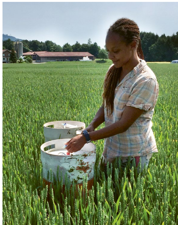
Détermination des émissions de gaz à effet de serre en grandes cultures : à l'aide de chambres manuelles, qui sont régulièrement fixées sur un anneau enfoncé dans le sol, on peut recueillir les gaz à effet de serre émis par le sol, les prélever peu de temps après avec une seringue (voir illustration) et les mesurer ensuite au laboratoire avec un chromatographe en phase gazeuse.
