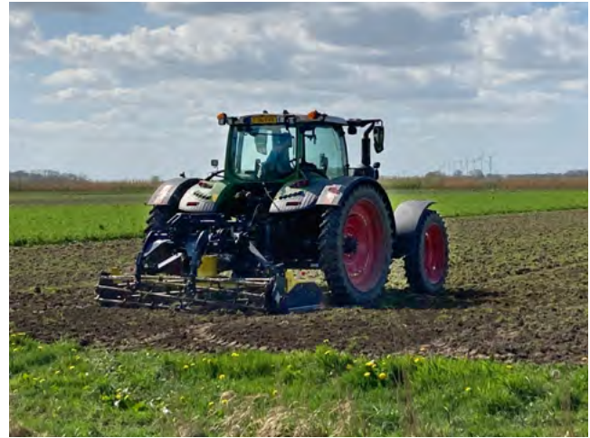
Fig. 4: Rotorharve efter traktor med udvidet sporvidde og smalle hjul til behandling af 3 m striber. Let jordbehandling med rotorharve. Holland. Foto: Erik Fog
