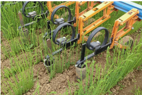
Cu distanțe suficient de mari dintre rânduri, buruienile pot fi controlate cu prășitoare.
