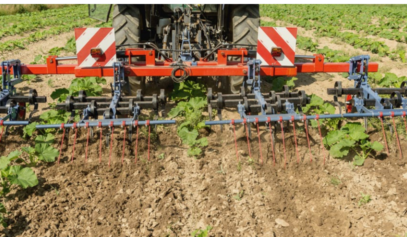
În loc de o țesală, se poate folosi grapa adaptată pentru spațierea largă a rândurilor.
