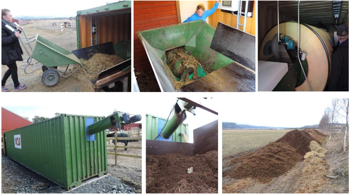
Bilde 7. Bildeserie som viser trommelkompostering ved Skjetlein vgs. Flisblandet møkk tømmeres i en beholder der den føres v.h.a. en skrue inn i trommelen. Trommelen er plassert i en konteiner. Bearbeidet masse legges i en kompostranke. Foto: Kirsty McKinnon
