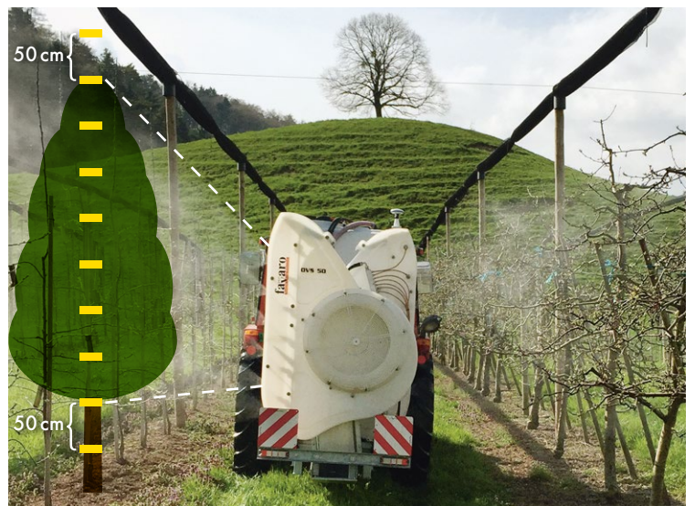
Direcția optimă a fluxului de aer și gradul de umectare pot fi verificate cu ajutorul hârtiei sensibile la apă în interiorul, deasupra și sub coroana pomului.
