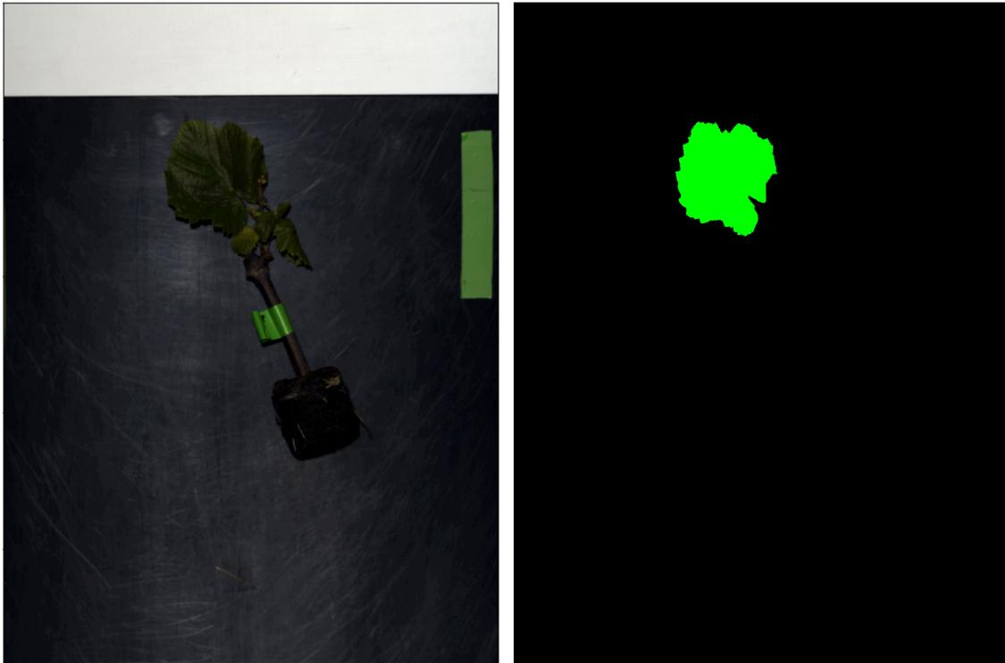
Abbildung 6: Aufnahme des neu erstellten UV-Vorversuch Datensatzes. Die hyperspektrale Aufnahme wird hier zur Veranschaulichung als RGB Bild dargestellt (links). Zu sehen ist ein Weinsteckling wobei ein Blatt mit UV-C Licht bestrahlt wurde, zur Untersuchung der Induktion der Stilbensynthese. Das bestrahlte Blatt wurde von den Projektpartnern annotiert und liegt als binäre Masken vor (rechts).
