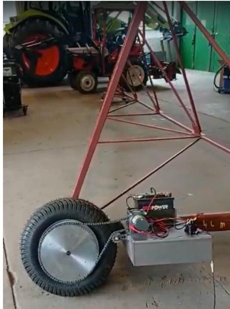
*Abbildung 10: Auslaufvariante 1a – Antriebseinheit für den rotierenden Auslauf.*
