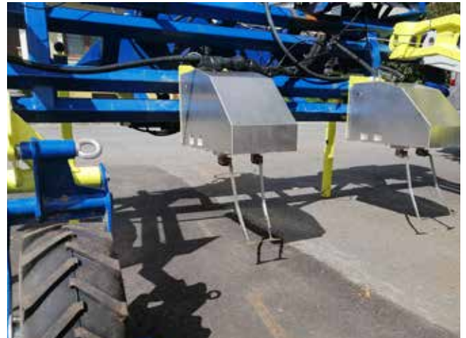
Abb. 12: Mit InRowHacken ist eine Regulierung der Beikräuter in der Kulturpflanzenreihe bei bestimmten Kulturen möglich.
