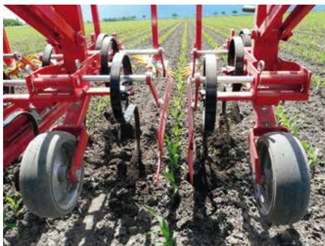
Abb. 8: Hacke mit Gänsefußscharen mit guter Wirkung zwischen den Reihen.
