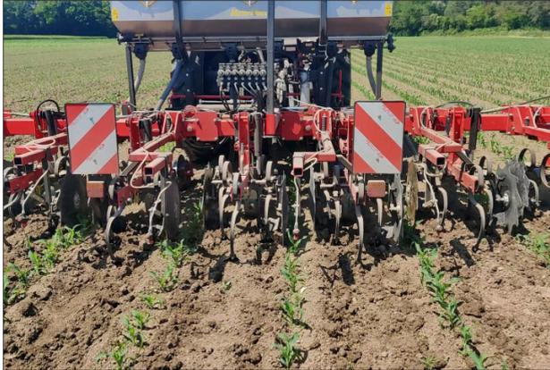
Hackgerät mit Oberlenker, Nachlaufsteuerung und Düsen für Bandspritzung. (Bild: zvg)
