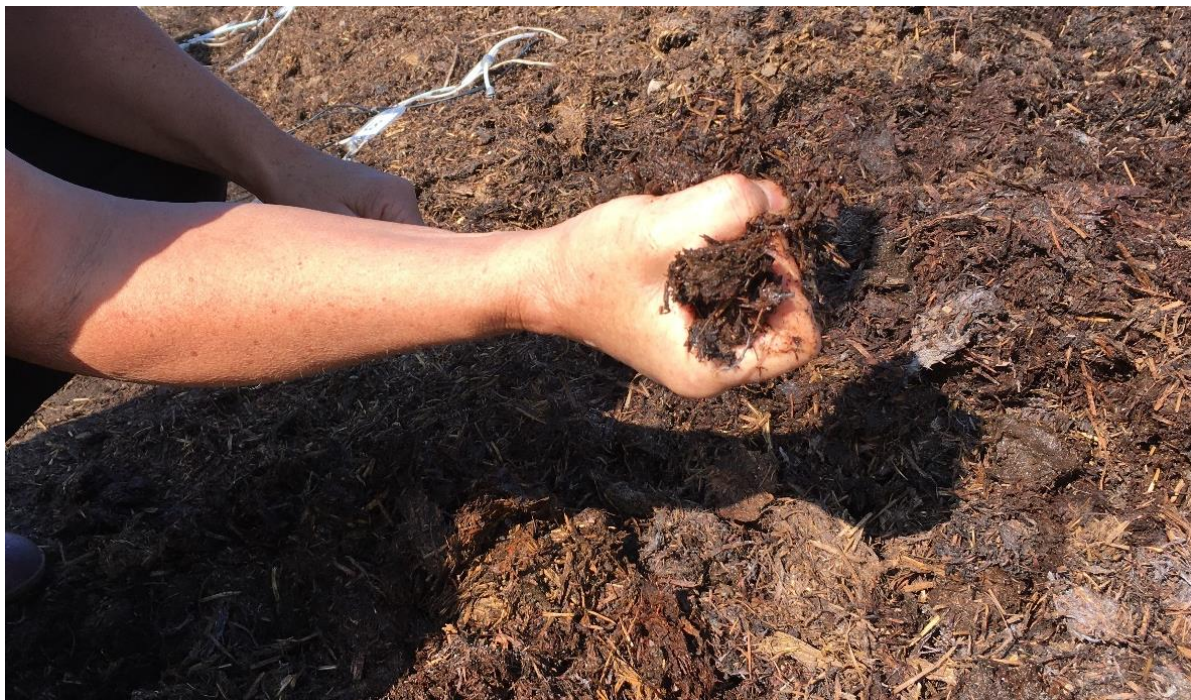
Bilde 7. Det er viktig å følge med på temperatur, fuktighet og utvikling av CO 2 i komposteringsprosessen. Her vises knyttneveprøven. Massen skal være akkurat så fuktig at det kan presses ut noen dråper med vann. Foto: R. Pommeresche
