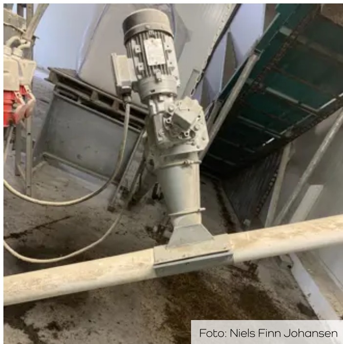
Skaller doseres ind på foderindføringsneglen
