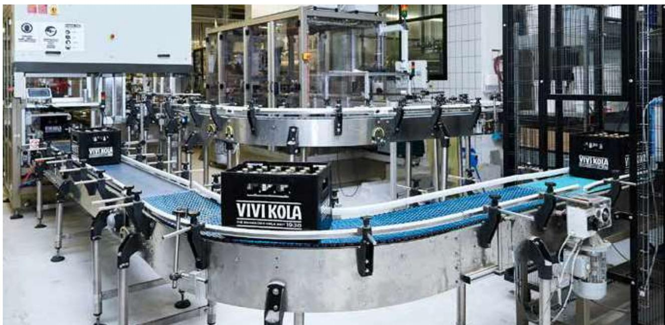
Le tapis roulant de la nouvelle installation d'embouteillage d'Eglisau ZH fait passer jusqu'à 5000 bouteilles et canettes à l'heure. *Photo: Vivikola*
