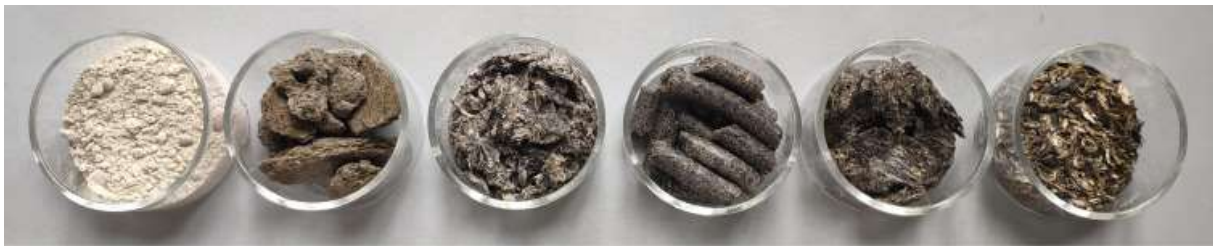
Abbildung 2: Beispiele für im Projekt bearbeitete Sonnenblumenpresskuchen (von links nach rechts: aus vollständig geschälten Saaten; aus 90% geschälten Saaten; aus 70% geschälten Saaten; aus ungeschälten Saaten; heißgepresst aus ungeschälten Saaten; heißgepresst aus ungeschälten Saaten und extrahiert mit Hexan).
