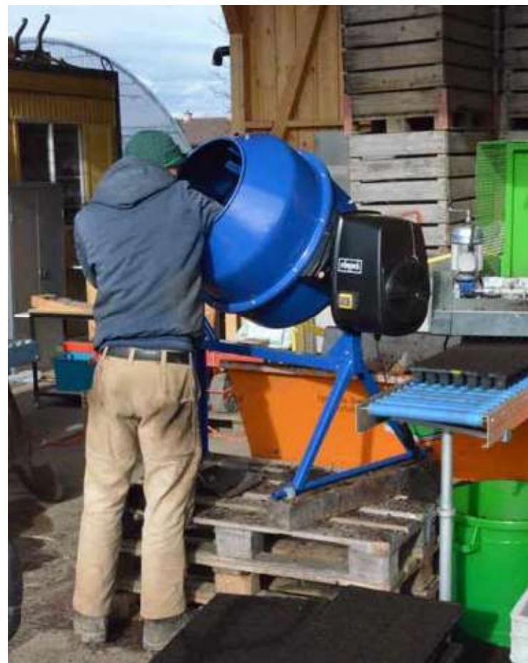
Das Abfüllen der Multitopfplatten erfolgt an der Trayfüllmaschine.
