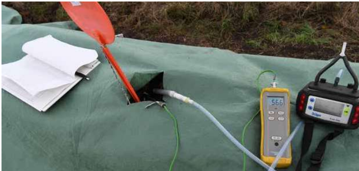
Instrumente zur kontinuierlichen Messung der Gaszusammensetzung sowie der Temperatur in den mit Vlies abgedeckten Kompostmieten.
