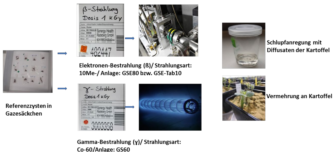
Abbildung 8: Ablauf der ionisierenden Bestrahlung: Gazesäckchen mit Zysten werden auf dem Boden einer Pappschachtel festgeklebt, diese wurde von außen für die jeweilige Behandlung/Strahlungsart und -dosis beschriftet, mit Gamma- oder Elektronenbestrahlung behandelt. Mittels der bewährten Methoden Schlupftest und Biotest wurde die Überprüfung der Lebensfähigkeit und Entwicklungsfähigkeit der Referenznematodenzysten durchgeführt (Fotos: Internet-Auftritt Fa. Steris Ast).
