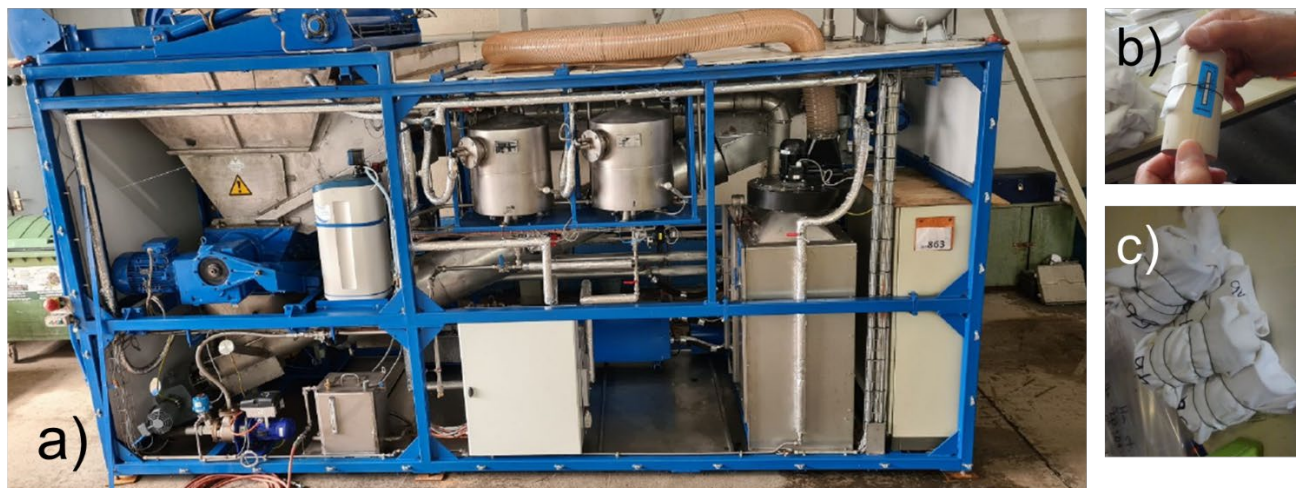
Abbildung 7: Geöffnete Anlage LOGMED I mit der diagonal verlaufenden, ummantelten Förderschnecke zur thermischen Behandlung des Transportgutes im Hintergrund und Einfülltrichter in der oberen linken Ecke ( a ). Holzprüfkörper mit seitlichem, durch Draht befestigtem Gazebeutel mit Referenzzysten und aufgeklebtem Temperaturmessstreifen ( b ) sowie diese nochmals vor Verlust geschützt in einem Baumwollsäckchen ( c ). (Quelle: zusammenfassender Bericht Rausch & Bastuck 2020, Nehlsen AG).
