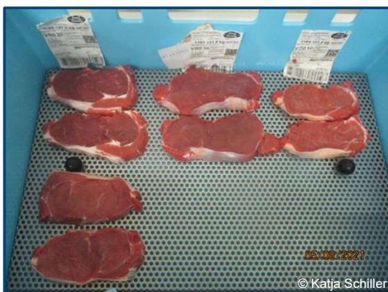
**Abbildung 3.3-2:** Tropfsaftverlustbestimmung im Technikum bei Edeka-Südwest Fleisch.
