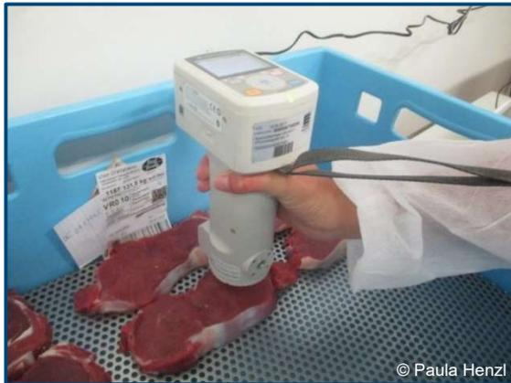
**Abbildung 3.3-3:** Farbmessung im Technikum bei Edeka-Südwest Fleisch.
