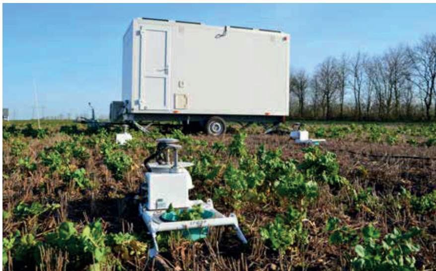
Måling af lattergasudledning fra en mark med olieræddike som efterafgrøde. Kamrene måler automatisk og typisk fire gange i døgnnet.
