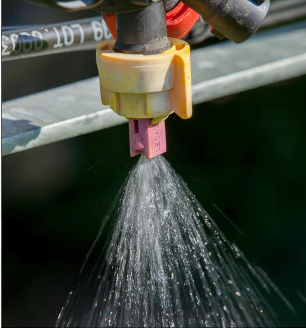
Mit der Injektordüse und dem angepassten Druck wird der Sprühnebel signifikant reduziert. (Bild: zvg)
